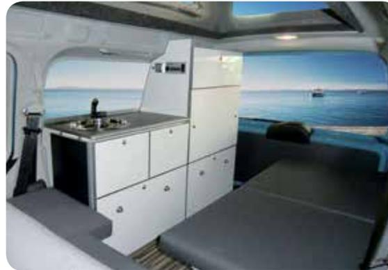
Komplette Miniküche mit Edelstahlspüle, Wasseranlage mit 13 L Frisch- und 13 L Abwasser, Gaskartuschenkocher, tragbare Kompressor-Kühlbox, sowie 12 V Anlage mit Wohnraumbatterie.
