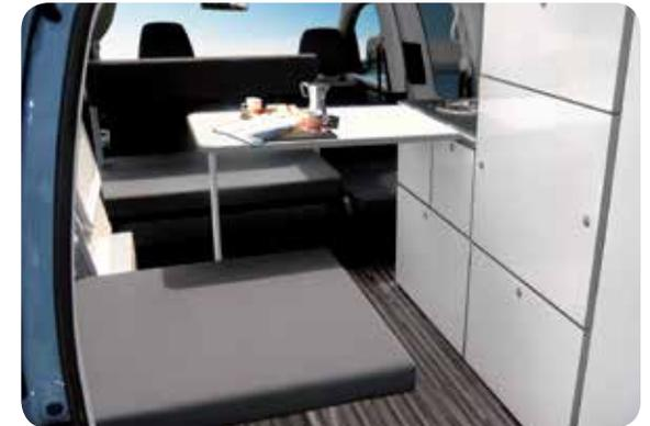
Schiebetisch für maximale Flexibilität. Wird der Tisch nicht benötigt, kann dieser an der Heckklappe verstaut werden.
