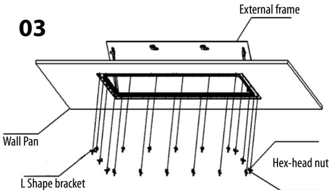
Schritt 3: Befestigen Sie den Winkel (L-Form) auf jedem Gewinde und schrauben Sie dann die Sechskantmutter, stellen Sie sicher, dass Sie diese nicht zu fest ziehen.
