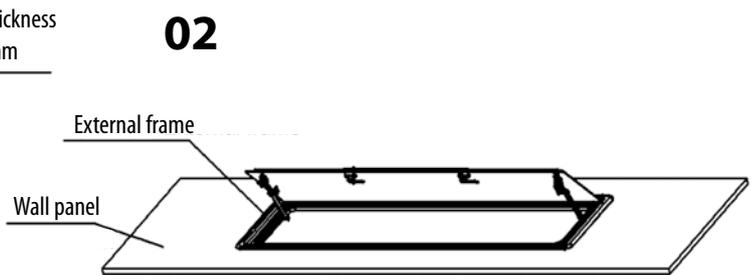
Schritt 2: Tragen Sie Silikon- oder Schaumstoff rund um die Fensterkante auf und montieren Sie das Fenster.
