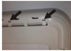
Lüftungsgitter demontieren (nicht zu stark durchbiegen) und die darunter befindlichen Schrauben lösen. Die zwei Abdeckkappen neben der Kurbel entfernen und die Schrauben ebenfalls lösen. Montage erfolgt in umgekehrter Reihenfolge.
