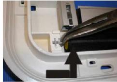
Innenrahmen wie unter Austausch des Innenrahmens beschrieben demontieren. Mit Hilfe einer Spitzzange Federmotor aus Aufnahmebock lösen.
