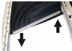
Das Rollo kann anschließend durch Verkanten des Abschlussstabes aus dem Innenrahmen entfernt werden. Beim Verkanten ist darauf zu achten, dass die Oberflächenbeschichtung des Rollostoffes (nur Verdunklungsrollo) nicht beschädigt wird. In umgekehrter Reihenfolge erfolgt der Einbau, unter Berücksichtigung der Spannregel.
