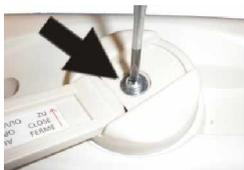
Vor dem Abnehmen des Innenrahmens ist darauf zu achten, dass die Kurbel in geschlossener Stellung bleibt, da sonst das Verhältnis von Kurbel zu Antriebssechskant nicht übereinstimmt. Innenrahmen wie unter Austausch des Innenrahmens beschrieben demontieren. Kurbel mit Hilfe eines Kreuzschlitzschraubendrehers demontieren, Neuteil in umgekehrter Reihenfolge montieren.
