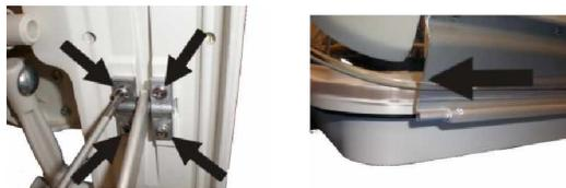
Den Glasrahmen mit Hilfe der Handkurbel komplett öffnen, um die Ausstellstangen der Hebevorrichtung zu lösen (à 4 Schrauben). Falls die Platzverhältnisse es zulassen, seitliche Fixierschraube im Rahmenscharnier auf einer Seite lösen. Den kompletten Glasrahmen aus dem Rahmenscharnier seitlich hinausschieben.
