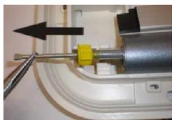
Rollo demontieren wie unter Austausch des Verdunklungsrollos und Austausch des Fliegenschutzrollos beschrieben. Federmotor seitlich aus Rollowelle herausziehen. Nach Überprüfung oder Austausch Federmotor in umgekehrter Reihenfolge montieren.
