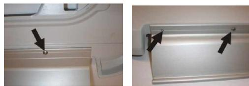
Falls keine Möglichkeit zur seitlichen Demontage besteht, muss das Scharnier am Glasrahmen demontiert werden (Kreuzschlitzschrauben). Bei der anschließenden Montage ist darauf zu achten, dass die einzelnen Arbeitsschritte in umgekehrter Reihenfolge ausgeführt werden.
