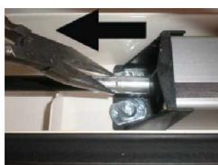
Innenrahmen wie unter Austausch des Innenrahmens beschrieben demontieren. Die 4 St. Kreuzschlitzschrauben lösen. Vor dem entnehmen der Hebevorrichtung die Antriebswelle vom Sechskant abziehen. In umgekehrter Reihenfolge Neuteil montieren.
